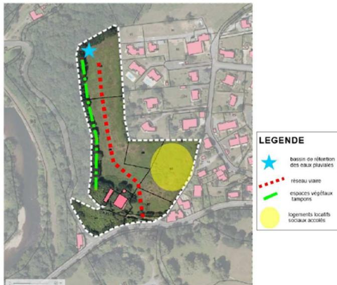
La création d'un réseau d'assainissement est à prévoir sur ce secteur comprenant la pose d'un réseau de 260 ml en Ø200. D'après le tracé topographique réalisé sur Géoportail la création d'un réseau gravitaire est suffisant pour se raccorder au réseau d'assainissement une étude plus avancée avec des levés topographiques est tout de même nécessaire pour le confirmer.
