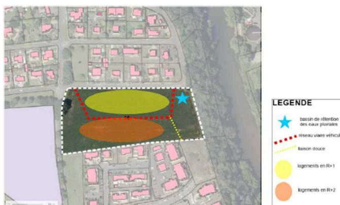
La création d'un réseau d'assainissement est à prévoir sur ce secteur comprenant la pose d'un réseau de 200 ml en Ø200. D'après le tracé topographique réalisé sur Géoportail la création d'un réseau gravitaire est suffisant pour se raccorder au réseau d'assainissement une étude plus avancée avec des levés topographiques est tout de même nécessaire pour le confirmer.
