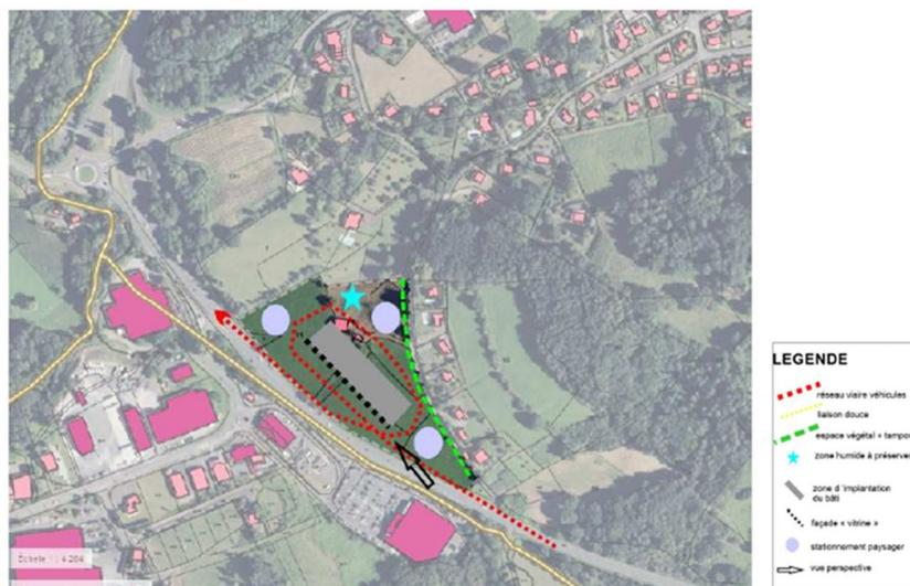
La création d'un réseau d'assainissement est à prévoir sur ce secteur comprenant la pose d'un réseau de 410 ml en Ø200 comprenant une plus-value dû à la traversée de la départementale sur 30 mètres.
